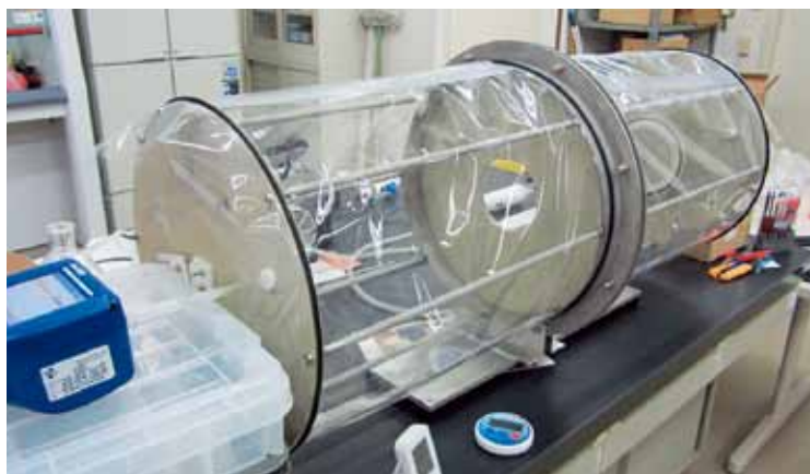
図1. 異なるエアロゾルを生成・反応させることが可能な分離式シュミレーション・チャンバー (容積126 L)
